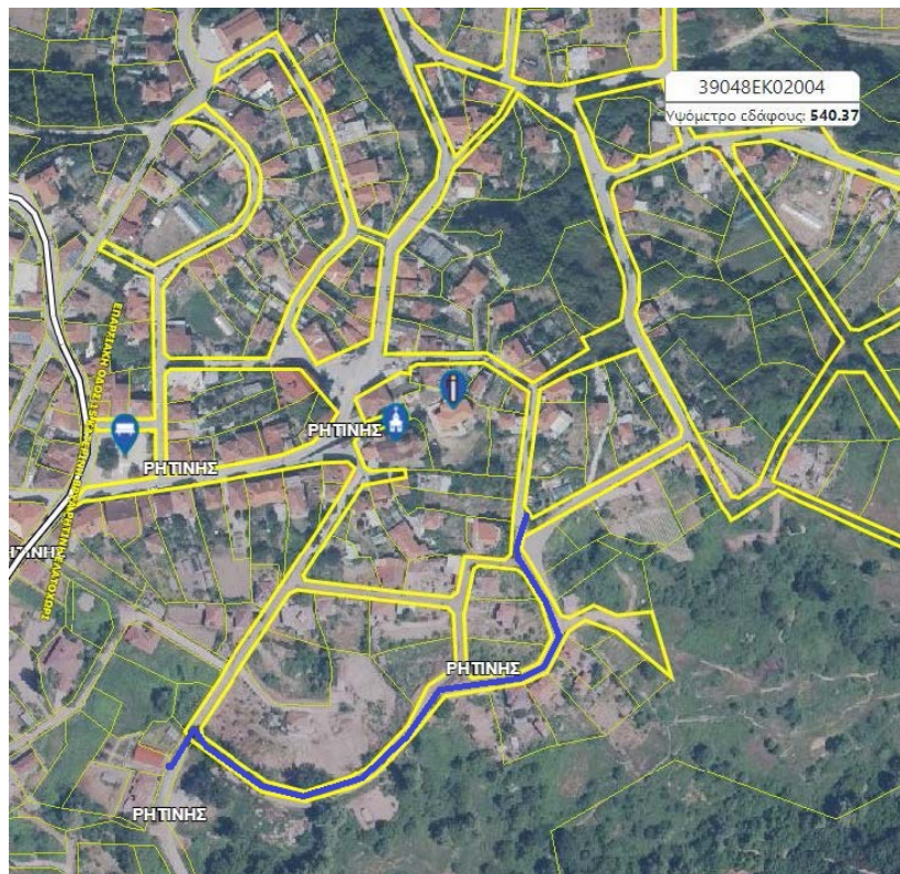
Σχήμα 2.3: Απόσπασμα ορθοφωτοχάρτη, όπου φαίνεται το ΚΑΕΚ 39048ΕΚ02004 (πηγή: http://maps.gov.gr/ ). Με μπλε χρώμα σημειώνεται η όδευση του αγωγού.
